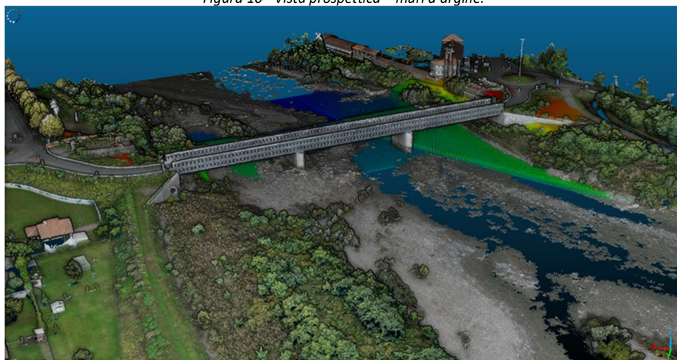
Figura 11 - inserimento DTM progetto in nuvola di punti.
